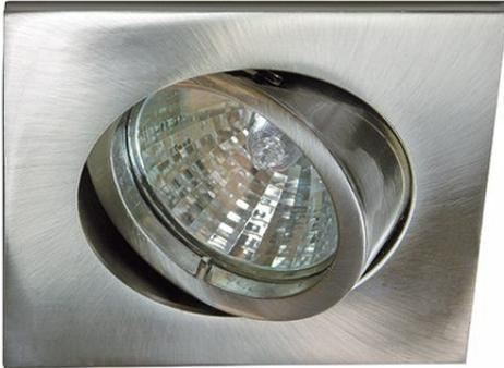
Artikel Nr. ALU5547+Farbcode ohne Sprengring, schwenkbar quadratisch, für  $\varnothing$  50 mm Leuchtmittel für die Innenanwendung Aluminium Druckguss Einbaustrahler 30° schwenkbar Leuchtmittelwechsel durch Herausnahme des Bajonett-Frontrings. exklusive Leuchtmittel
