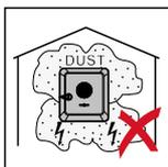
Grundsätzlich ist der Wechselrichter staubdicht (IP 66) ausgeführt. In Bereichen mit starker Staubansammlung können sich Staubablagerungen auf den Kühlflächen ansammeln und somit die thermische Leistungsfähigkeit beeinträchtigen. In diesem Fall ist eine regelmäßige Reinigung erforderlich siehe Kapitel **Betrieb in Umgebungen mit starker Staubentwicklung** auf Seite 137. Eine Montage in Räumen und Umgebungen mit starker Staubentwicklung ist daher nicht zu empfehlen.
